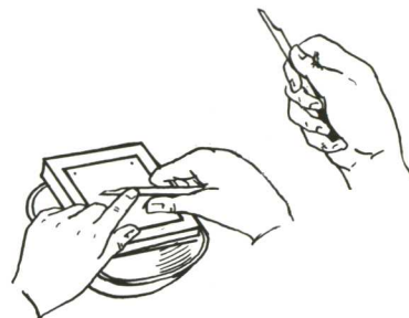
Илл. 9. Положение резца в процессе гравирования.
